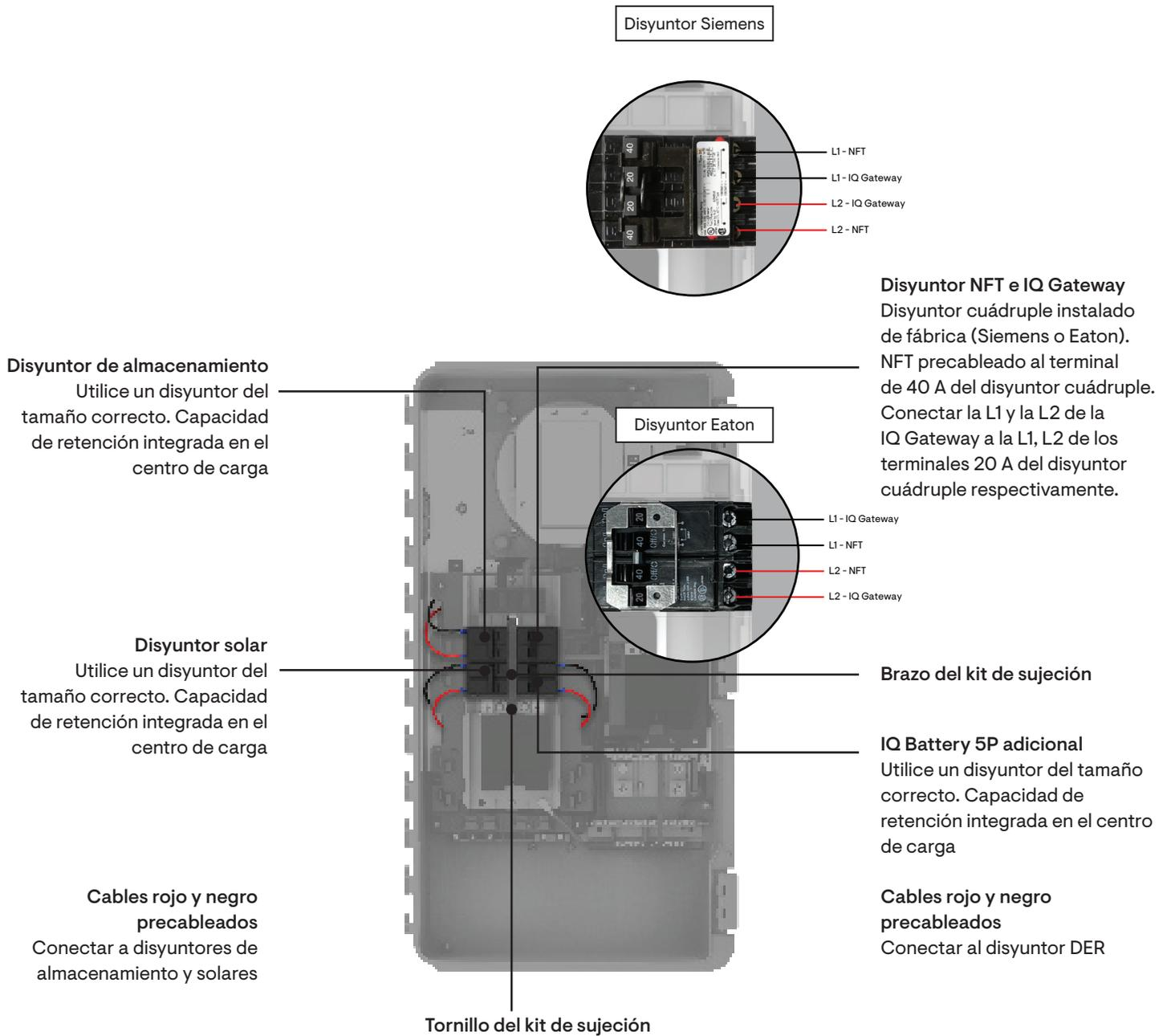
**Figura 1B: Instalación de los disyuntores DER para el IQ8 System con generador**
